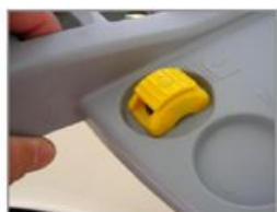
指触电子滚轮 控制上升下降
