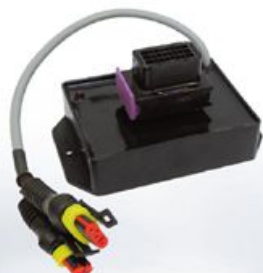
举升、下降电子控制 及PWM驱动器
